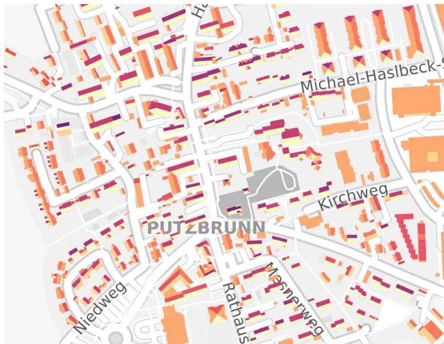
Abbildung 17: Beispielhafte Darstellung der mittleren Jahresglobalstrahlung auf Dachflächen des 3D-Gebäudemodells (LoD2) der Bayerischen Vermessungsverwaltung (Dunkelrot: Gering, Gelb: Hoch)
